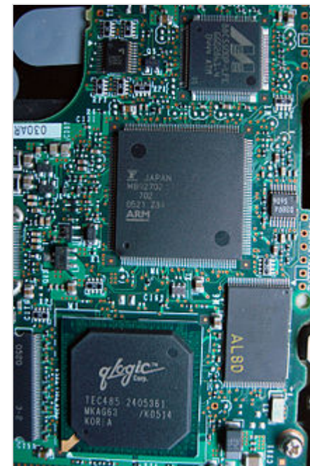
СБИС контроллера на плате управления жёстким диском Fujitsu MAP3735NC.
