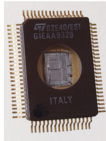
Микроконтроллер 1993 года с УФ-стиранием памяти 62E40 европейской фирмы STMicroelectronics .
