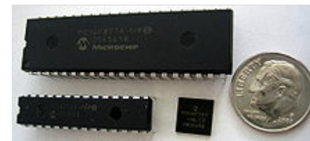
Микроконтроллеры серии PIC в корпусах DIP и QFN .
