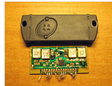
Гибридная микросборка STK403-090, извлечённая из корпуса
