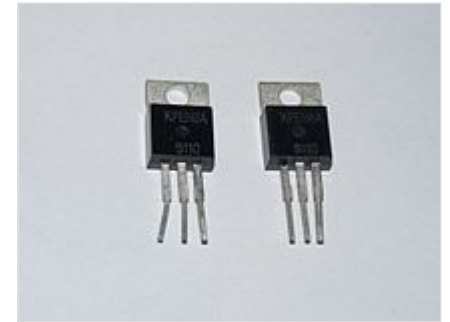
Микросхема стабилизатора напряжения КР1170ЕН8
