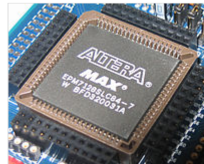
CPLD ПЛИС Altera MAX 7128, эквивалентная 2500 логическим вентилям
